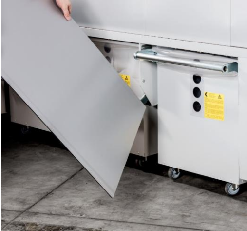
Spänecontainer mit Staubschott
