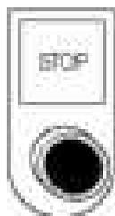
**TASTE STOPP BEARBEITUNG:** Stoppt den Werkstückvorschub und sämtliche Maschinenmotoren. Deaktiviert die Blasdüsen und das Aggregat zur Plattenreinigung. Taste drücken und Maschine stillsetzen.
