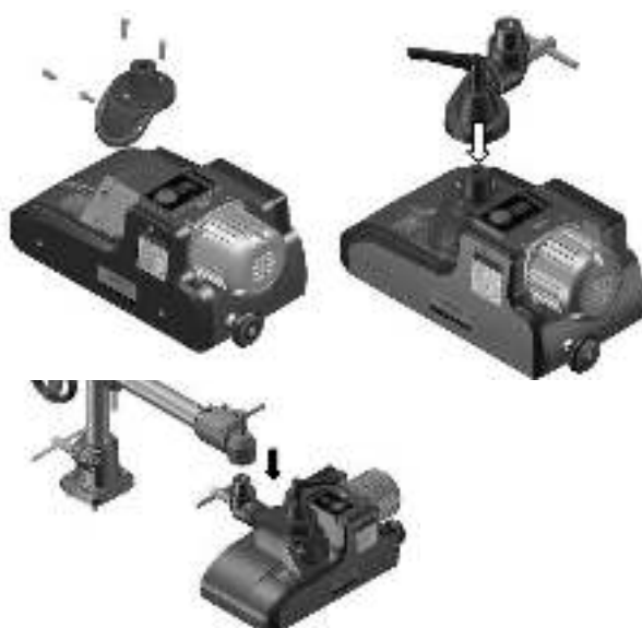
Abb. 24: 90°-Schwenkvorrichtung montieren (falls vorhanden)
