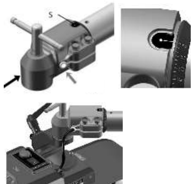
Abb. 20: Kabeldurchführung und Aufkleber
