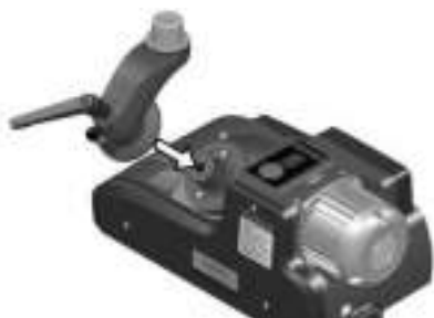
Abb. 22: Gelenk am Vorschubapparat montieren
