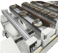
"Freie" Saugnäpfe, also nicht an den Arbeitstisch gekoppelt, jeder Saugnapf ist mit Sicherheitsarretierungen steif an die Stange gebunden: **mechanisch**, durch das untere Profil, das in die Oberfläche des Arbeitstisches eingeklemmt wird, und **pneumatisch** durch das bewegliche Seitenprofil, das sich über die Gesamtlänge des Tisches erstreckt, sich nach außen hin ausbreitet und den unteren Teil des Saugnapfs steif zusammendrückt.
