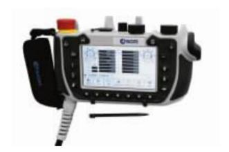
Bewegliches Steuerfeld womit an der Maschine mehrere Eingriffe ausgeführt werden können.
