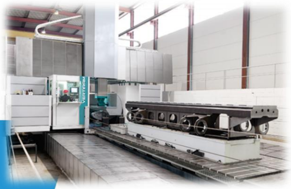
12m CNC Bearbeitungszentrum
