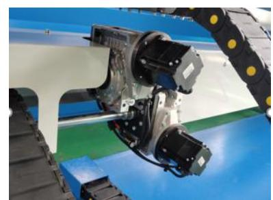
Die Bewegung der X-R-Achsen wird durch ein doppeltes Untersetzungsgetriebe gesteuert, das als "intelligentes" Design gilt und eine kompaktere Version ermöglicht hat.
