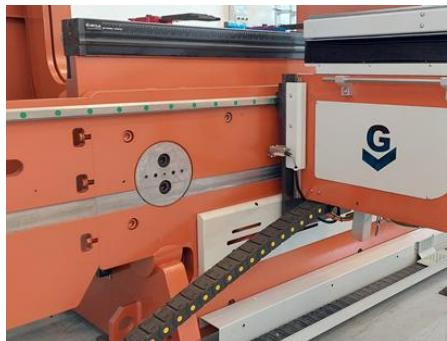
Im Vergleich zu Schweißkonstruktionen erfolgt bei der verschraubten Variante kein Wärmeeintrag in das Material. Das bedeutet, dass es keine Spannungen gibt, die zu ungewollten Verformungen des Systems und damit zu Ungenauigkeiten führen könnten.
