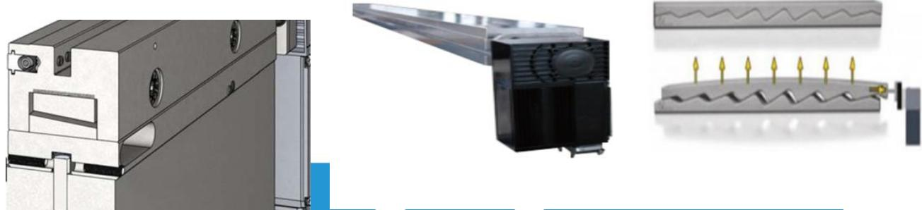
Jeder Satz Keilblöcke ist entsprechend der Durchbiegung des oberen und unteren Trägers ausgelegt. Die CNC berechnet den erforderlichen Kompensationswert entsprechend der Kraft, die zum Biegen des Werkstücks aufgebracht werden muss, und steuert automatisch die relative Bewegung des Keilblocks, um die Durchbiegung effektiv zu kompensieren.
