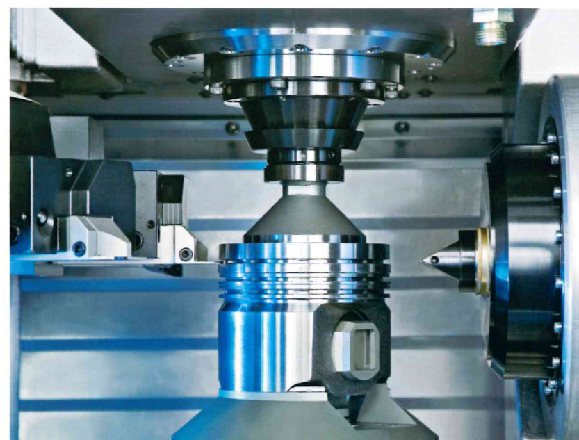
Stahlkolbenbearbeitung: Einstechen der Kolbennuten
