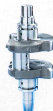
OP 50 Zentrisches Drehen (VTC 250)
