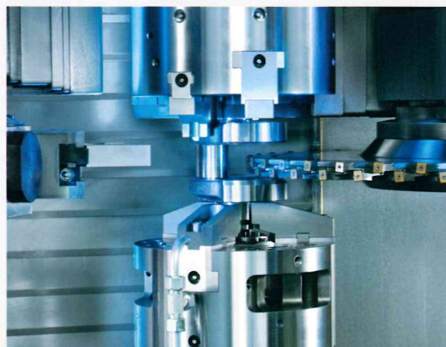
OP 30 Hublager fräsen (VTC 250 F)
