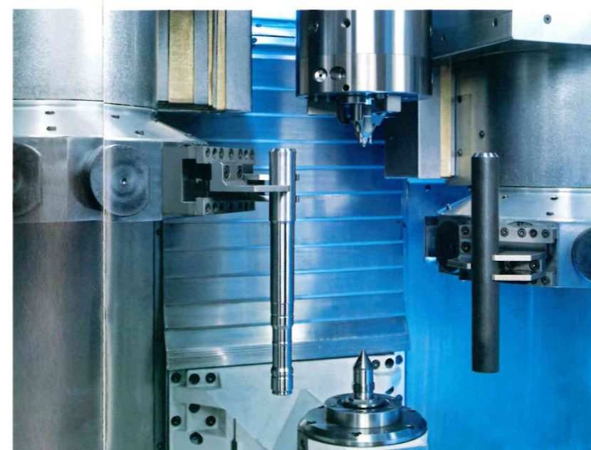
Teilewechsel: Fertigteil wird abgenommen und zur Ablage gebracht. Neues Rohteil wird zugeführt (Ablauf von rechts nach links)
