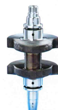
OP 60 Exzentrisches Drehen (VTC 250)
