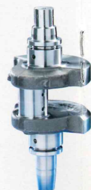
OP 40 Öllochbohren (EMAG HSC 800)
