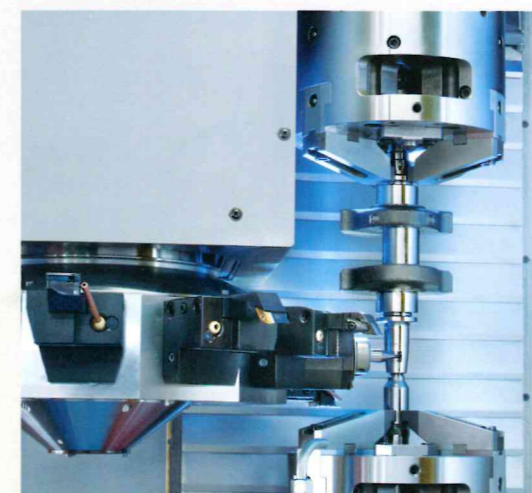
OP 50 Zentrisches Drehen (VTC 250)
