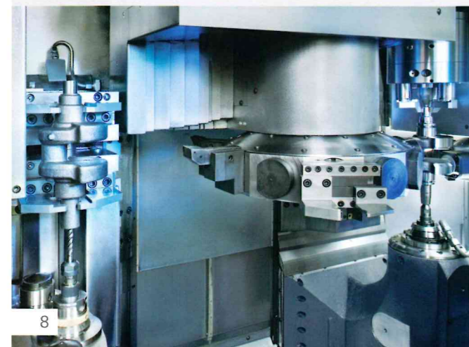
OP 10 + 20 Ablängen, Zentrieren, Drehen (VTC 250 DUO)
