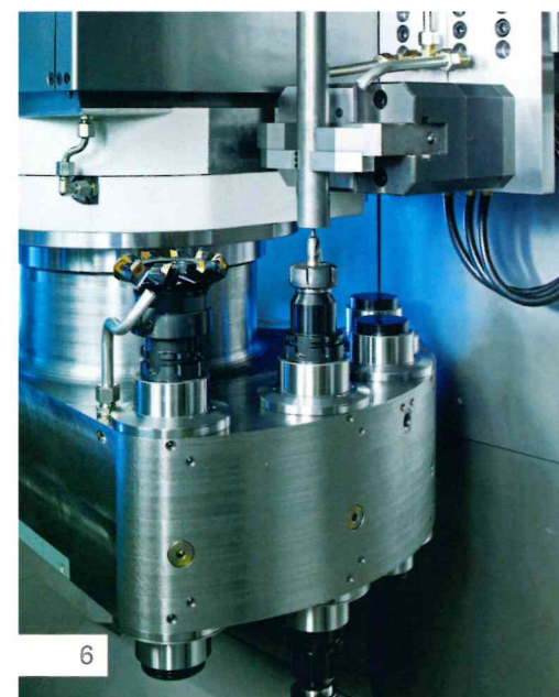
Wellenbearbeitung: Zentrieren und Endenbearbeitung
